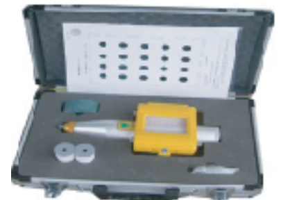
圧縮強度検査用シュミットハンマー
